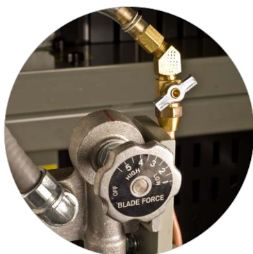
Control Automático de Fuerza de Corte
