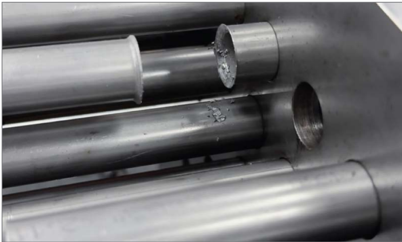
Figura 1. Ejemplo de no cortar el tubo en el lado opuesto, detrás de la placa tubular
