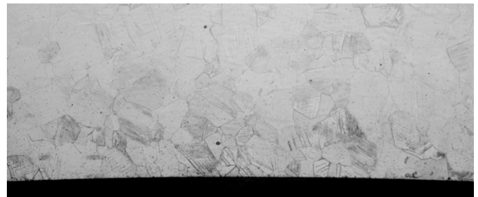
Figura 6. Expansión con Pasador Cónico con una Reducción del 6 % del Espesor de Pared
