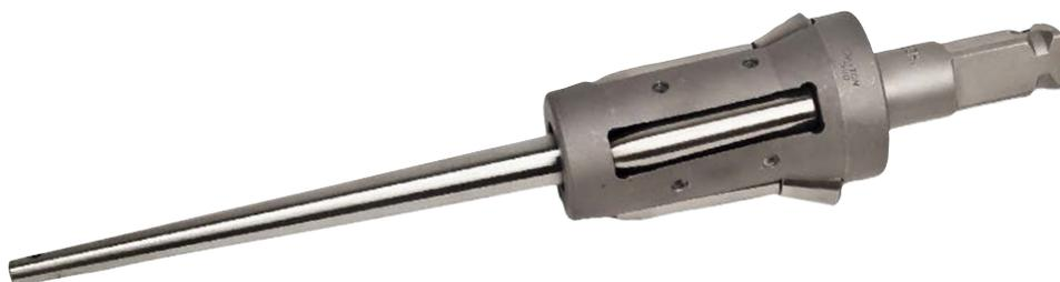
*Expansores Para Acampanar Tubos De Calderas Serie 1500 de avance automático han sido creados especialmente para ser usados en Calderas Piro y Acuotubulares. En una sola operación, estos expansores rolan los tubos y simultáneamente los acampanan proyectando la punta del tubo a 20 grados de la línea central de la herramienta.*
