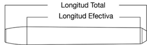
xx equivale el grosor de la placa. Agregue dos dígitos para el largo del rodillo deseado para la expansión y el número de parte del juego de rodillo.
