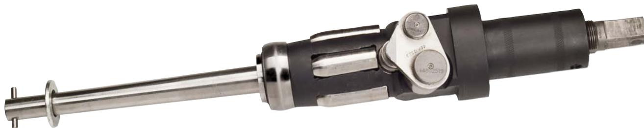
El Expansor Rebordeador De Un Rodillo de la Serie 4480, expande el tubo dentro de la placa mientras forma el rebordeado en la punta del tubo que se requiere en las aplicaciones de calderas piro tubulares.
