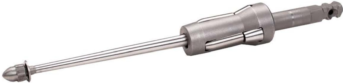
Los Expansores Para Acampanar Tubos De Calderas Serie 900 de Elliott creados específicamente para ser usados en tubos de recalentadores, calderas acuotubulares o evaporadores. En solo una operación, estos expansores rolan los tubos y simultáneamente los acampana proyectando la punta del tubo a 15 grados de la línea central de la herramienta.
