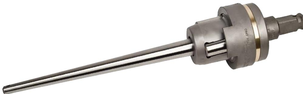
Los Expansores Rectos Para Calderas Serie 40 son recomendadas para el re-rolado de juntas mecánicas con fugas en calderas piro tubulares. De avance automático, estos expansores pueden ser usados manualmente o propulsados por un motor de rolado para mayor rapidez.
