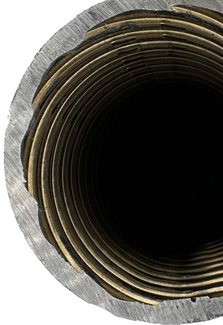
más tiempo de preparación, la calidad del reborde es significativamente mejor y da como resultado una transición uniforme del tubo al reborde. Al eliminar el realce antes de expandir, se prolonga la vida útil de la expansora de reborde de un rodillo y se evita que el realce aparezca en el reborde. Además, este método elimina la acumulación de material o crestas internas del proceso de expansión, reduciendo el riesgo de que gases calientes y llamas puedan crear un punto de fallo con el tiempo.
