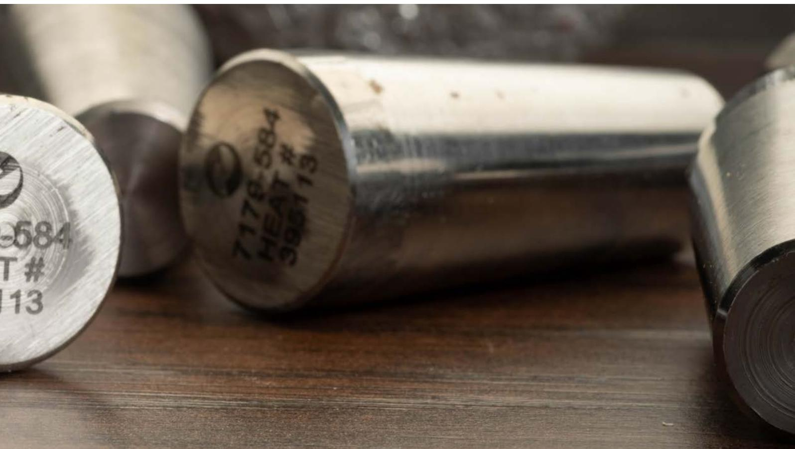
sino que apunta a un acero al carbono laminado en caliente "A" diferente con una composición química específica que coincide con la de SA-105.
