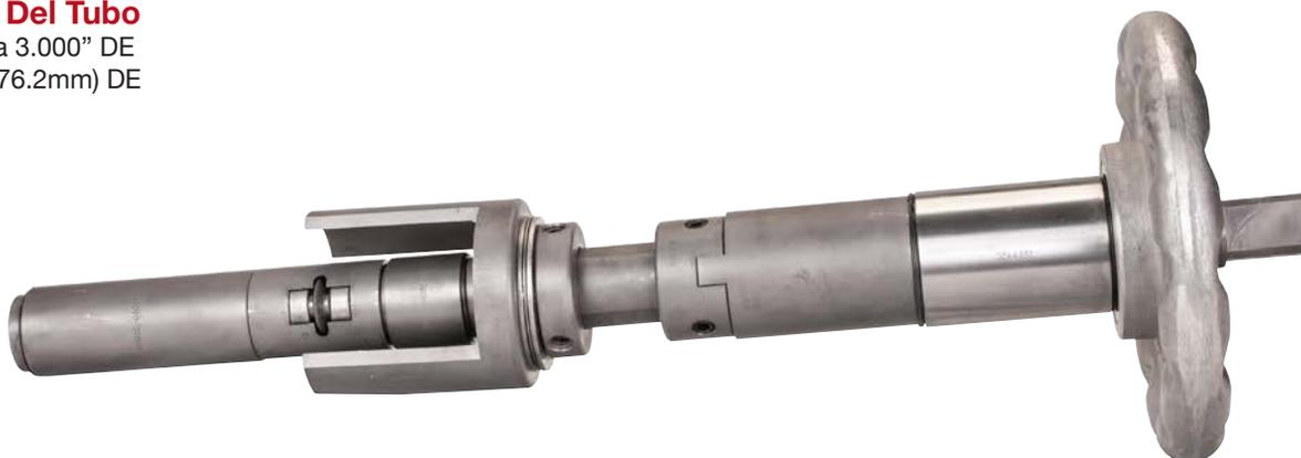
Los Cortadores de Tubos Para Calderas de la Serie 376 / 396 son accionados con motores eléctricos o neumáticos para poder cortar tubos en calderas piro y acuotubulares. El objetivo primordial de esta serie es cortar longitud de los tubos en su extremo común. Es muy importante que cuando vaya a usar un expansor rolador rebordeador, corte los tubos de manera pareja (del mismo largo) antes de proceder con el rebordeado.
