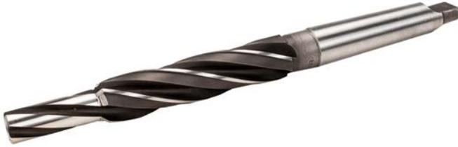
Estas herramientas especialmente diseñadas tienen una nariz tipo piloto para mantener el taladro centrado en el tubo. El taladro está dimensionado para dejar aproximadamente .015" de material de la pared en el tubo. El material restante luego puede removerse fácilmente con un botador de tubos y el martillo neumático.
